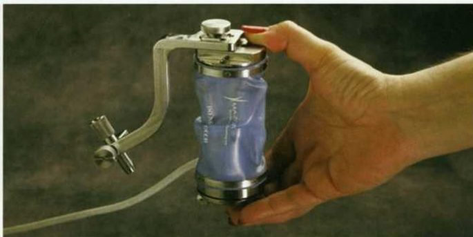
Der Miniatur-Hexapod-Roboter sieht aus wie eine Getränkedose und nutzt die Präzision von winzigen Gleichstrommotoren. Er hat bei einem Gewicht von 250 g einen Durchmesser von nur 50 mm und eine Höhe von 80 mm.
