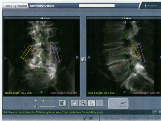
Die präoperative Planungsphase basiert auf einem CT-Scan der Wirbelsäule. Unter Berücksichtigung aller Einflussgrößen beträgt die Präzision der Positionierung unter 1,5 mm.
